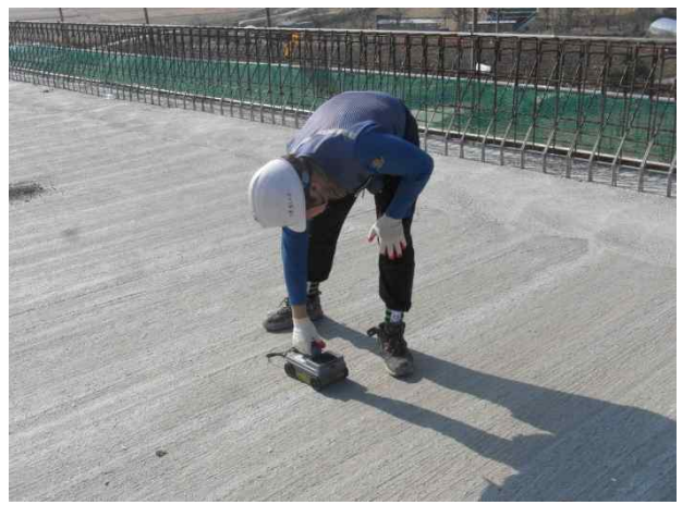
3S(영천방향) 슬래브 상면 철근배근탐사 전경
